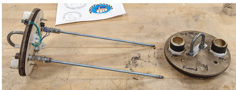
Figure 11: AV bay bulkheads.
